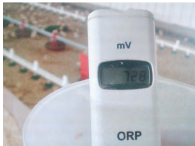
Figura 15: Medição da qualidade da água
